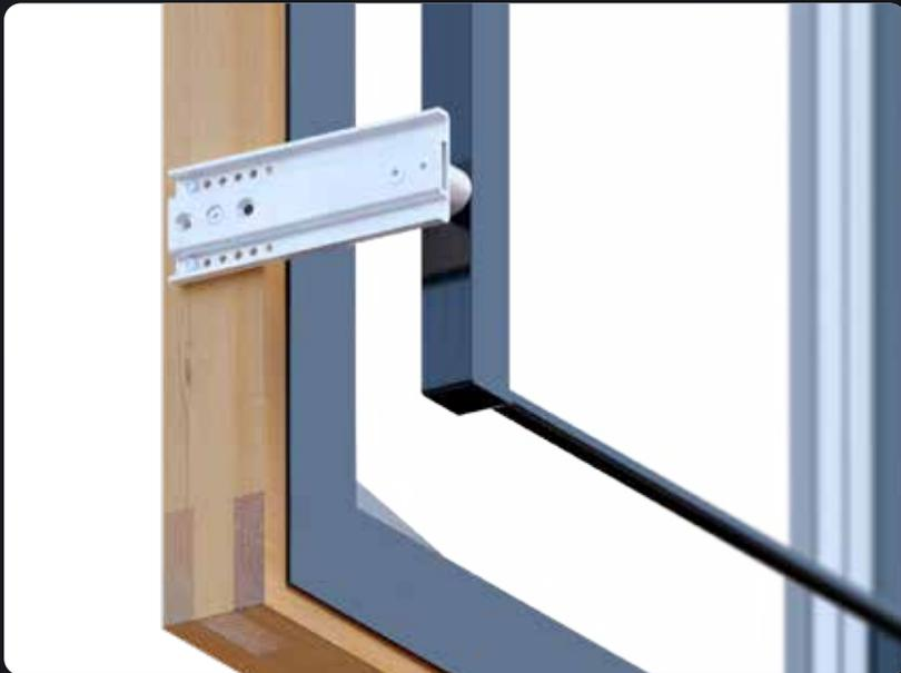
Befestigung der Absturzsicherung seitlich am Blendrahmen mittels Konsolen. Weitere Funktionselemente, wie Insektenschutzsysteme, Rollläden, Raffstore, etc. können zwischen Absturzsicherung und Fenster montiert werden.
